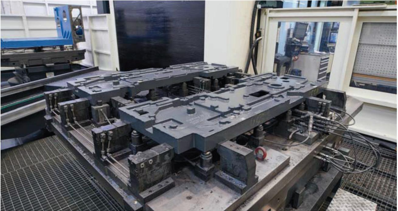
AMF hat auf einer DMC 340 U einfahrbare Maschinenpaletten mit rüstzeitminimierenden Spannlösungen ausgestattet. Das umfasst flexible Aufspannvorrichtungen für vier Varianten von Bauteilen, die stets paarweise gespannt werden.
